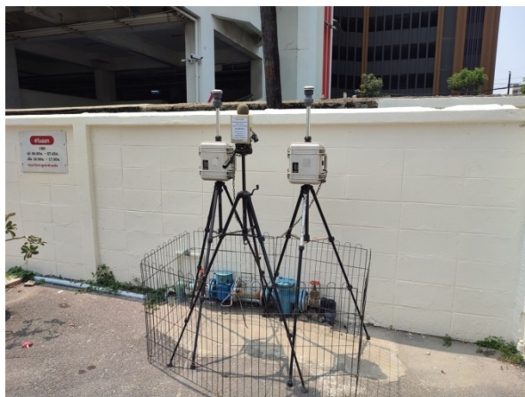
ติดตั้งเครื่องตรวจวัดฝุ่นละออง เครื่องตรวจวัดเสียง ที่โรงเรียน นิธิปริปัญญา
